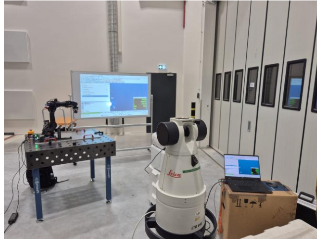
Rysunek 1. Stanowisko badawcze z robotem Astorino i trackerem Leica LTD840
