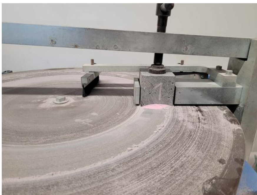
Rysunek 15. Badanie odporności na ścieranie
