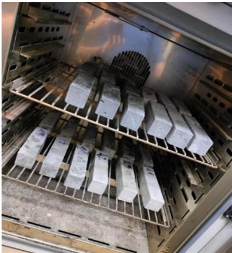
Rysunek 6. Badanie nasiąkliwości
