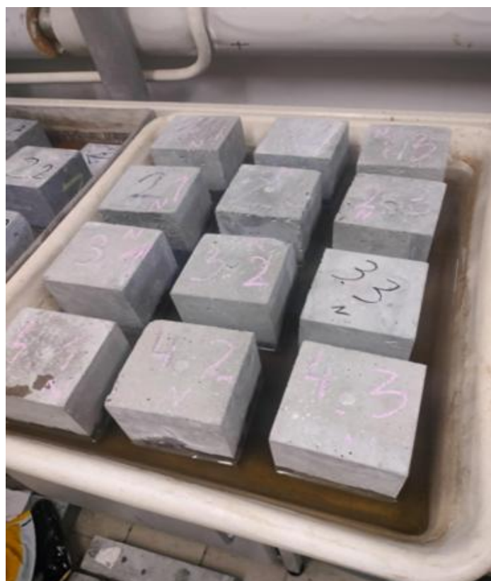
Rysunek 17. Badanie podciągania kapilarnego
