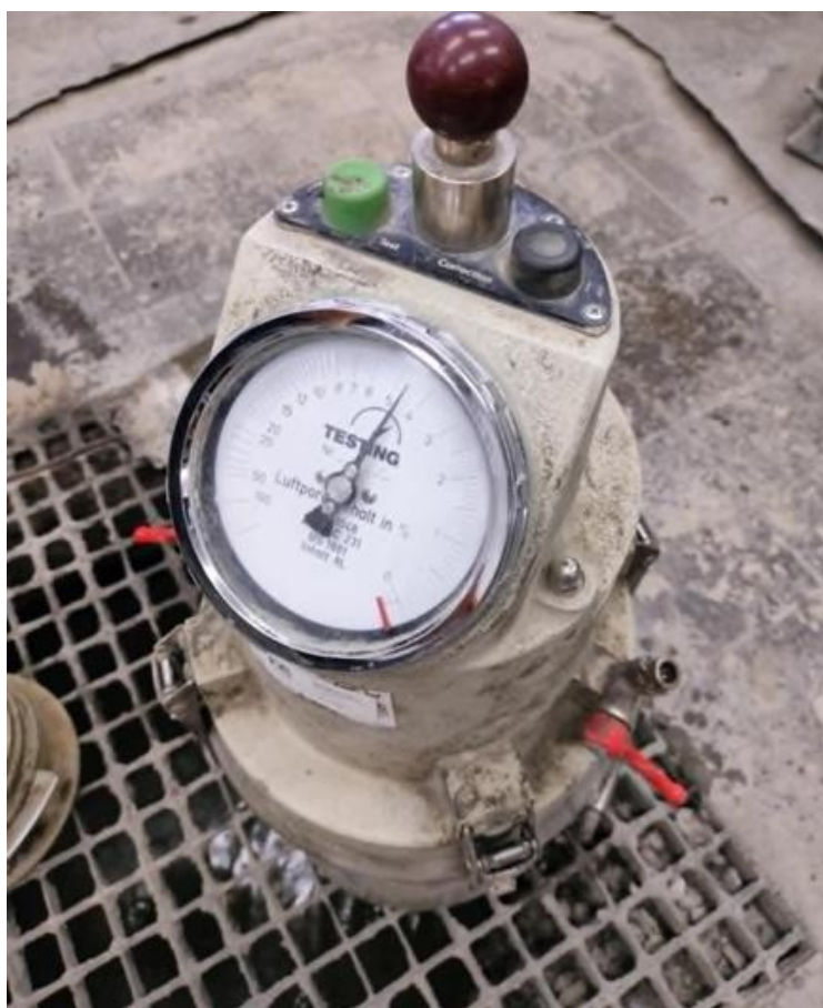
Rysunek 4. Badanie zawartości powietrza w mieszance betonowej
