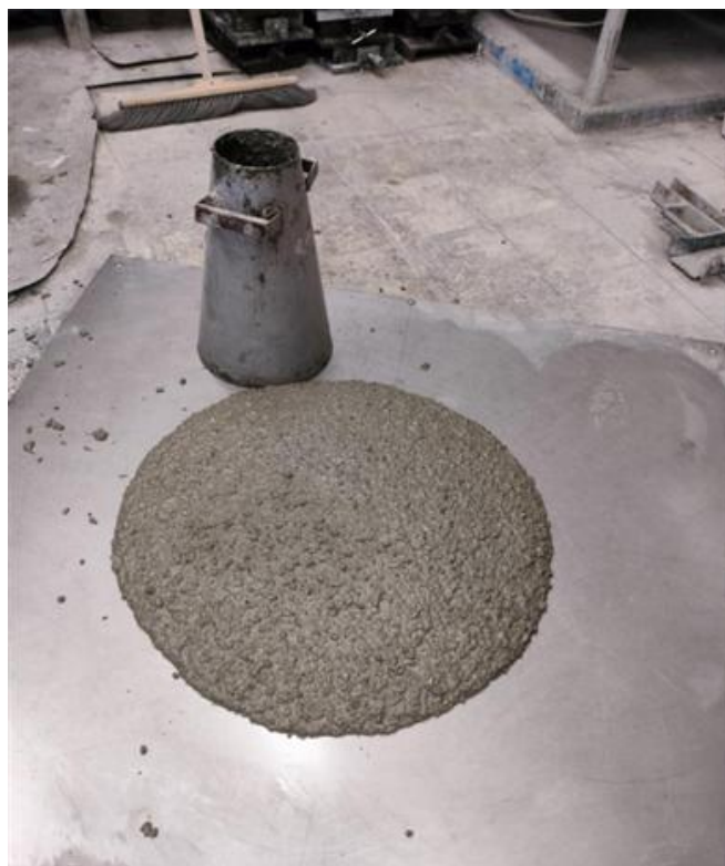
Rysunek 1. Badanie konsystencji mieszanki betonowej
