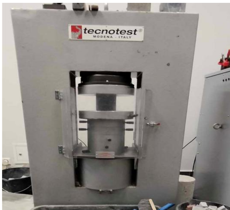
Rysunek 10. Badanie wytrzymałości na ściskanie
