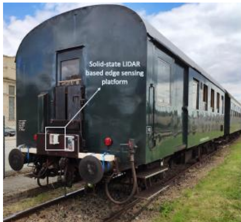
Rysunek 10. Platforma służąca do pomiaru dystansu [12]
