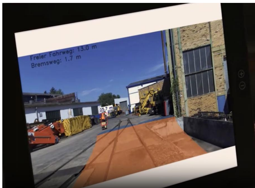
Rysunek 7. Obraz z kamery umieszczonej na lokomotywie wyświetlany w czasie rzeczywistym [11]
