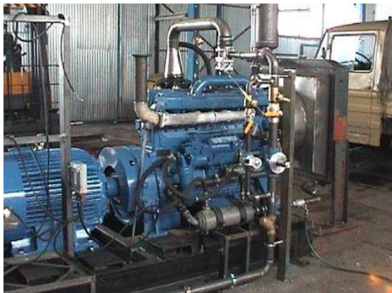
Rysunek 2. Zespół kogeneracyjny Autogas Projekt na bazie silnika SW680, silnik diesla przystosowany do pracy na gazie [32]
