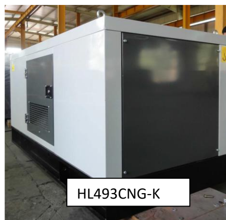
Rysunek 4. Agregat prądotwórczy na bazie silnika HL493CNG-K [36]
