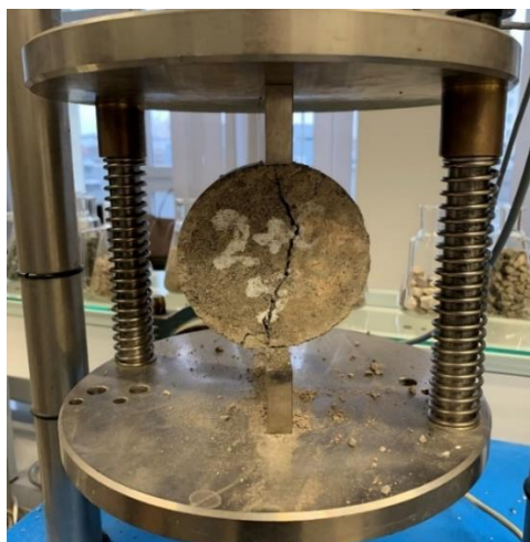
Rysunek 3. Moment zakończenia badania rozciągania pośredniego
