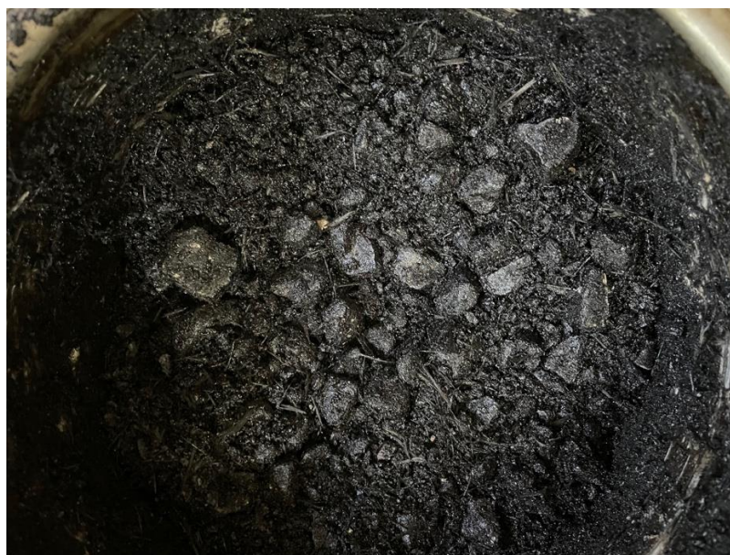
Rysunek 5. Mieszanie AC 16W z dodatkiem włókien
