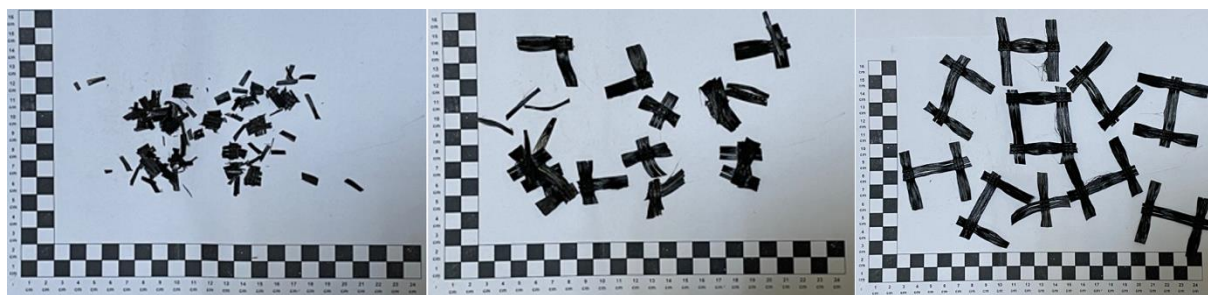
Rysunek 2. Mikro i makro włókna szklane
