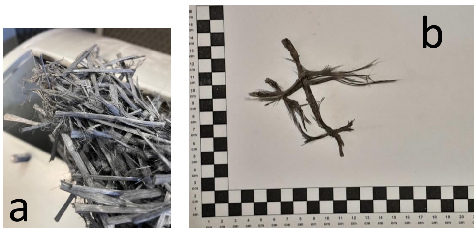
Rysunek 4: a) Nowe włókno geosiatki po procesie postarzania w bębnie Los Angeles b) Włókno geosiatki po procesie frezowania nawierzchni asfaltowej
