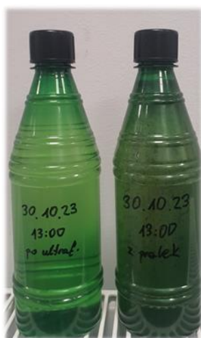
Rysunek 8. Porównanie wizualne ścieku surowego z uzyskanym permeatem (zdjęcie własne)
