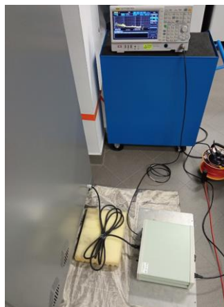
Rysunek 11. Widok stanowiska do pomiaru zaburzeń przewodzonych prototypu automatu sprzedającego
