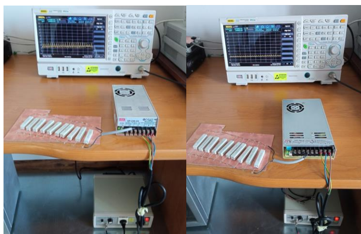
Rysunek 3. Widok stanowiska pomiarowego z zasilaczem Mean Well SP240-24 po lewej, oraz MeanWell RSP320-24 po prawej
