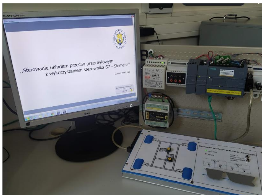
Rysunek 3. Stanowisko laboratoryjne do sterowania układem przeciw-przechyłowym
