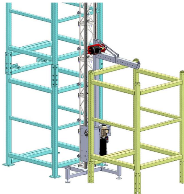
Figure 4. Żuraw wraz z przygotowanym do uniesienia modułem
