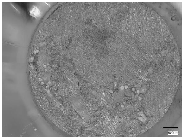
Rysunek 3. Morfologia powierzchni próbki stali X20Cr13 z powłoką VTMS/PEDOT/BRIJ po badaniach korozyjnych w roztworze 0,5 \text{ mol dm}^{-3} \text{ Na}_2\text{SO}_4 + 0,5 \text{ mol dm}^{-3} \text{ NaCl} pH = 2. Mikroskop cyfrowy KEYENCE VHX – 7000, pow. 50
