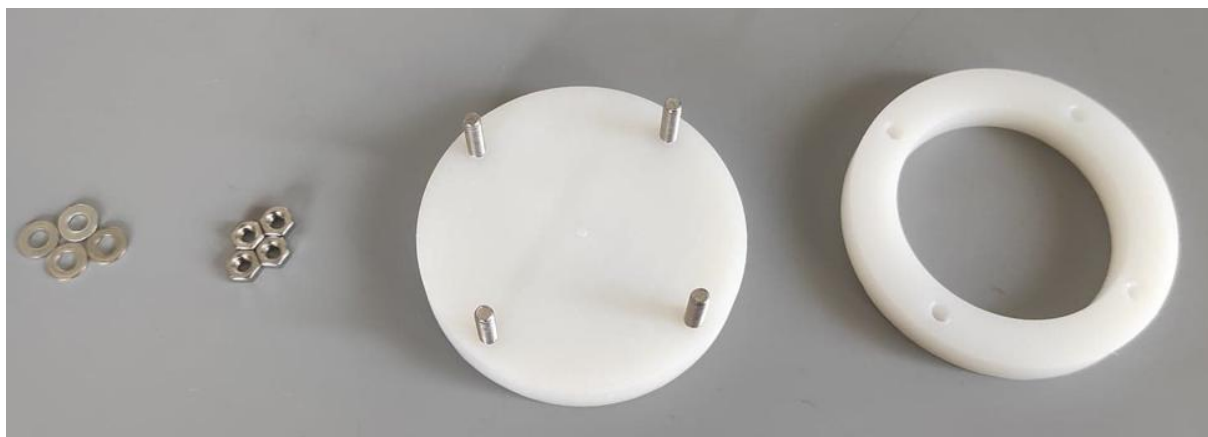
Rycina 8. Aparaty do badania szybkości uwalniania substancji czynnych z PTFE
