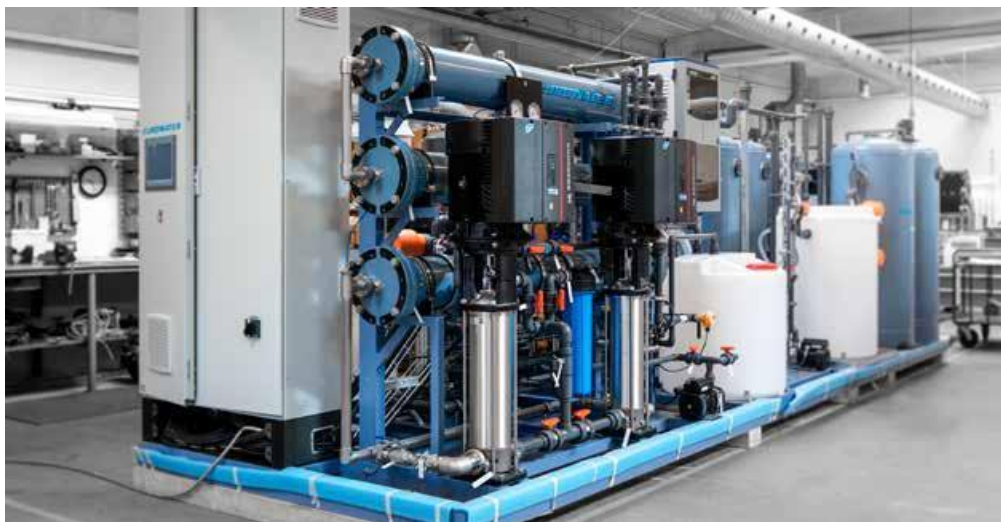
Rysunek 5. Stacja uzdatniania wody metodą membranową (odwrócona osmoza)
