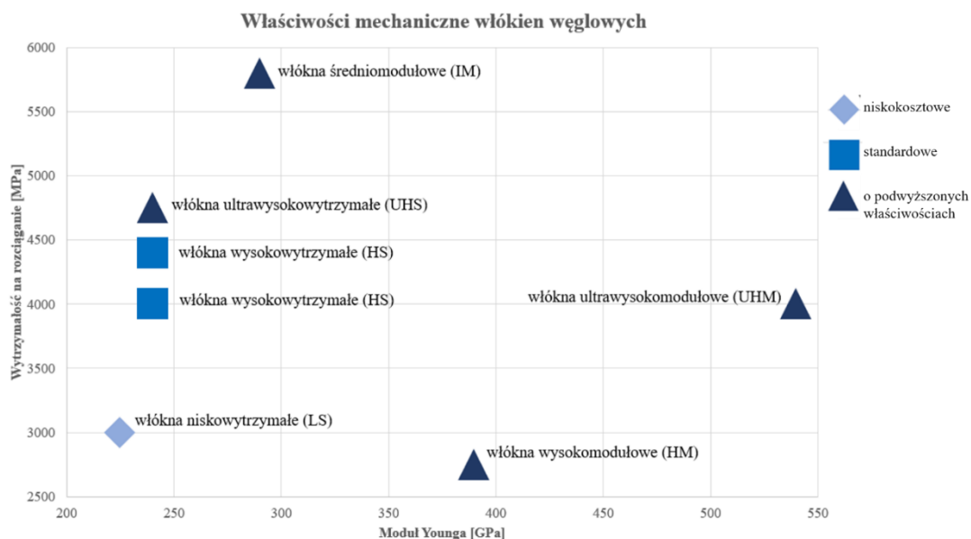
Rysunek 3. Klasyfikacja włókien węglowych według ich właściwości mechanicznych
