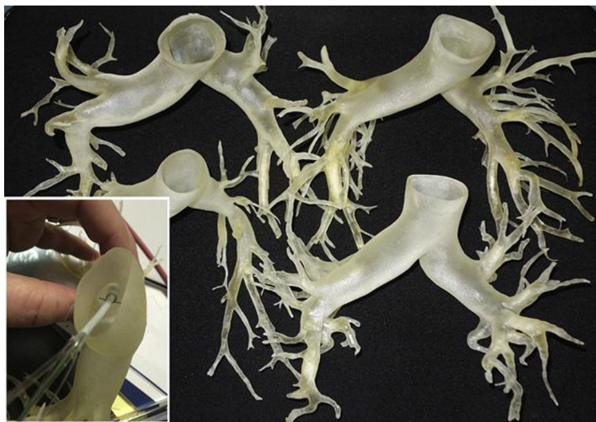
Rysunek 3. Modele tętnicy płucnej z zastawkami wydrukowane metodą SLA z elastycznego materiału podczas testowania prototypu cewnika
