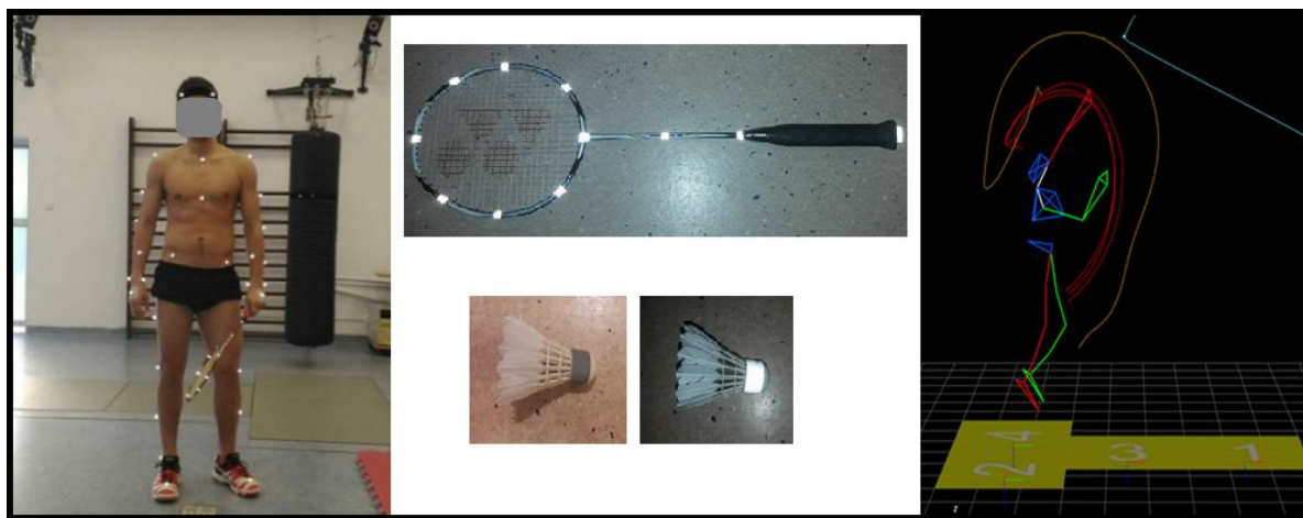
Ryc. 1 . Przygotowanie do pomiarów: zawodnik, rakieta i lotka z naklejonymi odblaskowymi znacznikami oraz trójwymiarowy model zawodnika stworzy w oprogramowaniu Mokka Software
