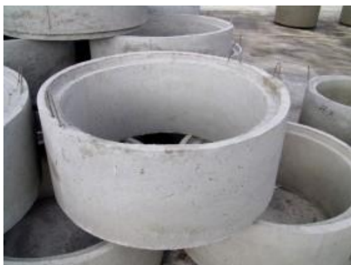
Rysunek 1. Prefabrykowany element betonowy wytworzony z mieszanki betonowej o konsystencji K-1
