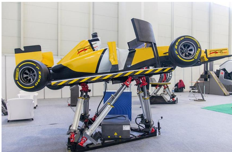
Rysunek 13. Symulator 6DOF F1 firmy ARCSIM
