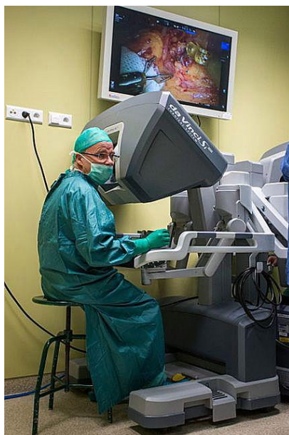
Rysunek 4. Panel operatorski robota Da Vinci [15]
