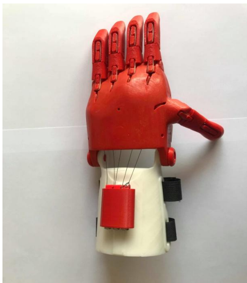
Rysunek 9. Proteza wykonana przy użyciu technologii druku 3D – widok od strony zewnętrznej
