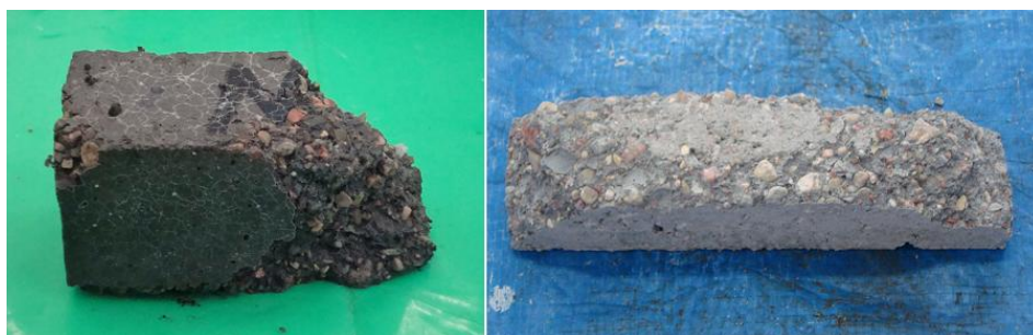
Fotografia 3. Próbki po wyjęciu z komory do badania mrozoodporności: próbka z 1 serii (bez domieszki), po 90 cyklach (fotografia po lewej) i próbka z 2 serii (z 0,1% domieszki napowietrzającej), po 75 cyklach (fotografia po prawej)
