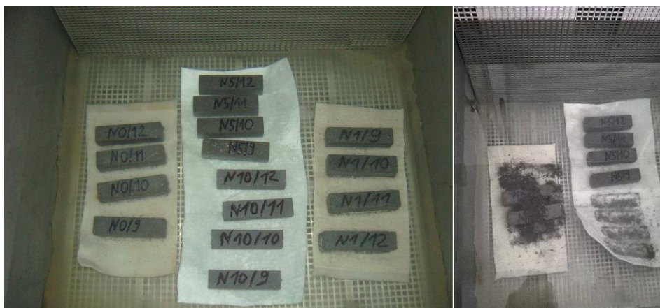
Fotografia 2. Próbki wszystkich serii w komorze do badania mrozoodporności (fotografia po lewej); wpływ cyklicznego zamrażania i rozmrażania na próbki betonowe (fotografia po prawej)
