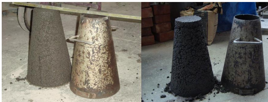
Fotografia 1. Stożek wykonany z mieszanki betonowej bez domieszki (fotografia po lewej) i z domieszką napowietrzającą w ilości 1,0 % w stosunku do masy cementu (fotografia po prawej)
