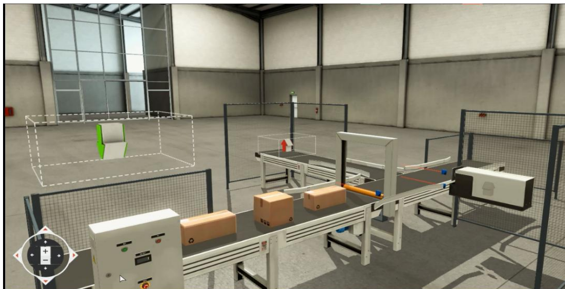
Rys. 7. Boczny zrzut ekranu na linię produkcyjną - sortownik pudeł. Pudła zostały rozdzielone poprzez działanie siłownika
