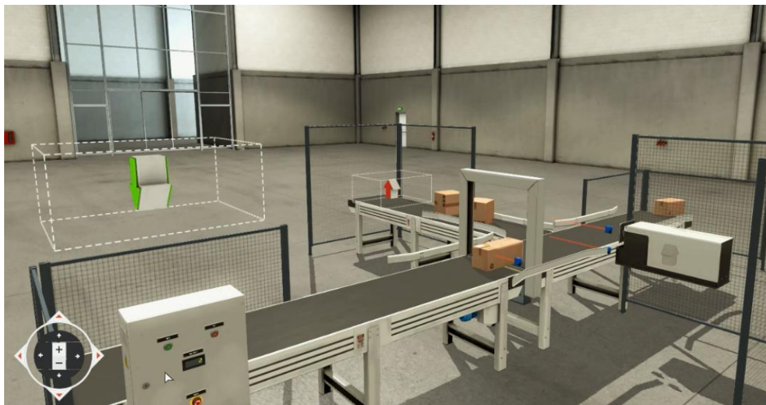
Rys. 6. Boczny zrzut ekranu na linię produkcyjną - sortownik pudeł. Pudła wjeżdżają przed „stoper”
