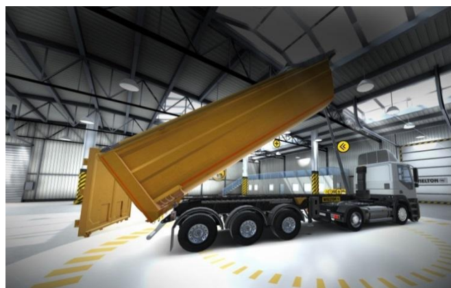
Rys. 12. Siłownik hydrauliczny teleskopowy, wykorzystany w układzie podnoszenia naczepy samochodu ciężarowego
