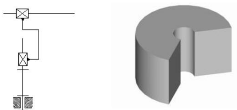
Rysunek 3. Schemat konfiguracji robota cylindrycznego oraz jego przestrzeń robocza
